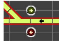
Al seleccionar Cambiar a la izquierda, la aguja seleccionará la bifurcación izquierda (punto rojo) o la de la derecha (punto verde). RailMaster envía automáticamente dos impulsos al motor de la aguja para asegurarse de que se haya movido.
