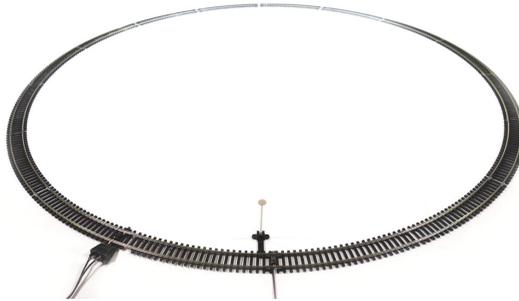
En un tramo conecta un sensor de vía del sistema de Detección de locomotoras.
