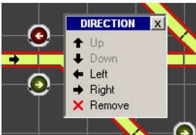
Al diseñar circuitos de gran tamaño es útil indicar la dirección normal del desplazamiento en determinadas líneas. RailMaster te permite añadir indicadores de dirección a los tramos verticales y horizontales.
