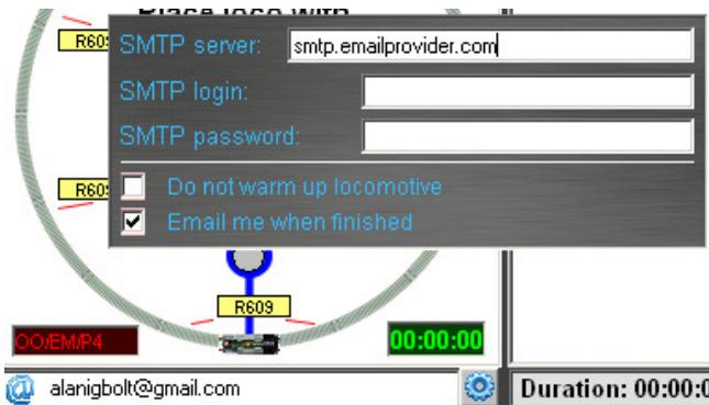
Para ello, pulsa el botón de configuración e introduce el servidor SMTP de tu sistema de correo electrónico y la dirección a la que deseas que se te envíe el correo. Si una locomotora no pasa por el sensor de la vía cuando RailMaster lo espera, el programa te enviará un correo para informarte.
