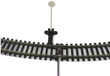
Para cada locomotora con perfil, añade una pequeña banda reflectante a la parte inferior de la locomotora, y asegúrate de que quede a entre 1 mm y 4 mm del sensor de la vía. Utiliza almohadillas autoadhesivas para acercar más la banda al sensor.
