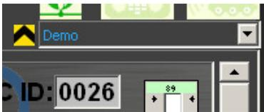
Si has configurado locomotoras como pertenecientes a grupos de locomotoras, verás que aparece una lista desplegable en la parte superior derecha de la ventana de control principal de RailMaster, encima del área de control de locomotoras.
