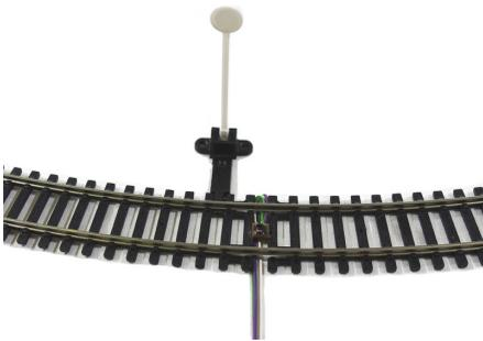
Pour chaque loco profilée, vous devez ajouter une petite bande réfléchissante à la face inférieure de la loco, en vérifiant qu'elle se trouve à une distance entre 1 et 4 mm du capteur sur voie. Vous pouvez utiliser des cales d'épaisseur autocollantes pour rapprocher la bande du capteur.
